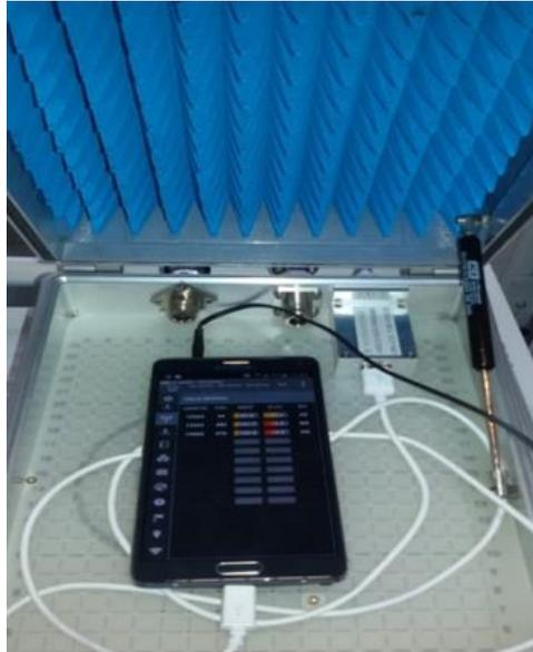
Figura 3.1 - Dispositivo all'interno del box anecoico
